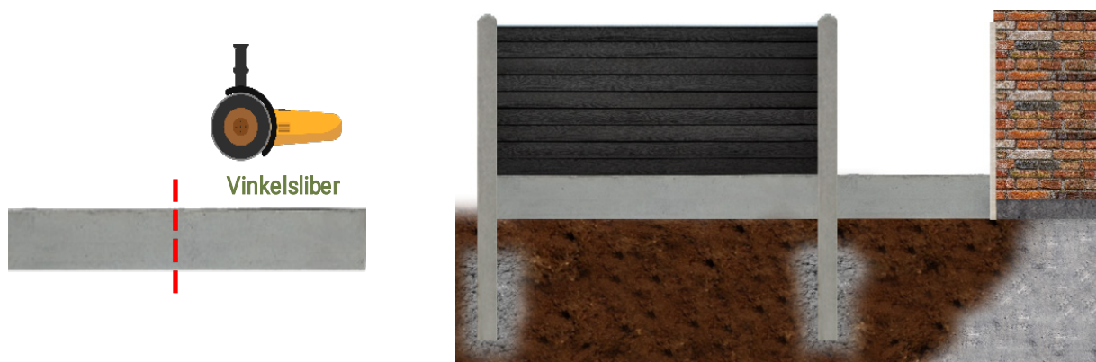
2.1 Tilskær hegnspladen med en vinkelsliber, i det ønskede mål, som blev fundet i punkt 1.1
